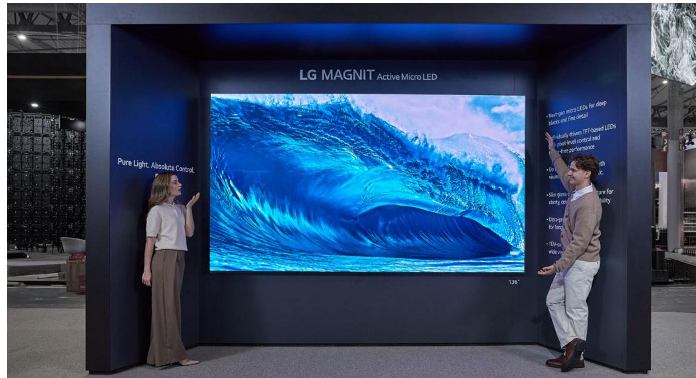
El diseño modular permite el montaje sin fisuras de los *cabinets* LED, lo que permite una escalabilidad sin límite. Y, además, el sistema de instalación se ha mejorado y ahora es posible el acceso frontal que facilita el ajuste entre los *cabinets*. Al mismo tiempo, se pueden instalar las [pantallas LED](#) y disponer los controladores a una distancia de hasta 10 kilómetros entre ambos.
