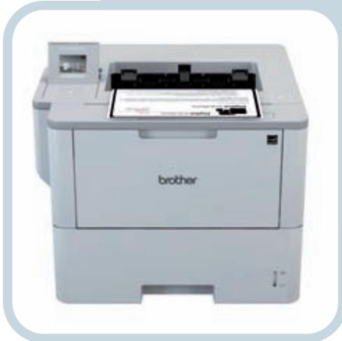
nectividad *wifi* o red cableada —dependiendo del modelo— y pueden escanear desde dispositivos móviles. Disponen de un alimentador automático de documentos (ADF) para 50 hojas, pantalla táctil color LDC y otras herramientas para garantizar la productividad como el software control center 4, tecnología NFC, acceso
